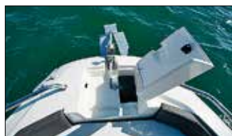
La baille est prévue pour recevoir également un guindeau électrique.
