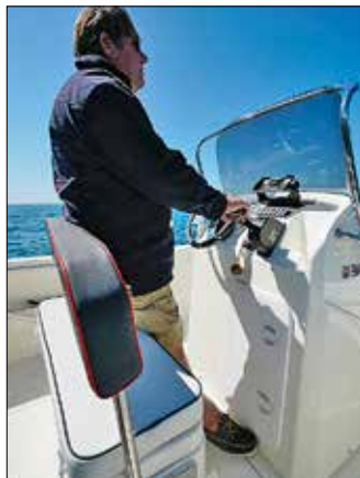
Le pilote peut se caler debout, en appui fessier, en rabattant le dossier de l'assise.
